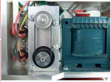
Moteur d'entraînement puissant de 3x 400 V pour des vitesses de soudage élevées.
