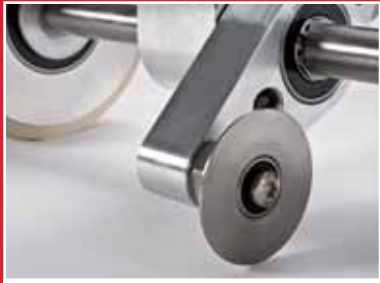
Un rouleau de guidage maintient le cours du TAPEMAT.
