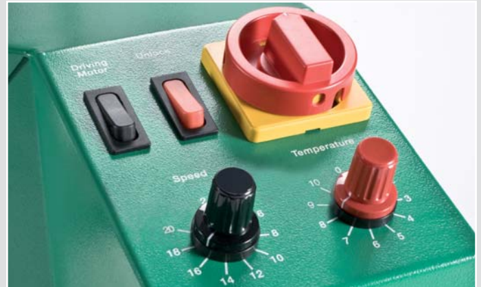
Le panneau de commande synoptique offre un contrôle des paramètres de soudure importants comme la température et la vitesse.
