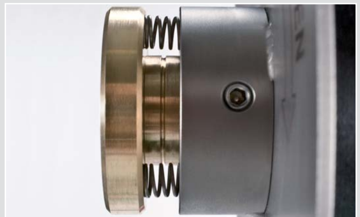
Un disque de frein à tension assure un déroulement constant de la sangle.
